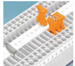
P-DI ayırma bıçağı ile devre istendiğinde ayrılabilir, yerine ters takılarak kaybolması önlenir
